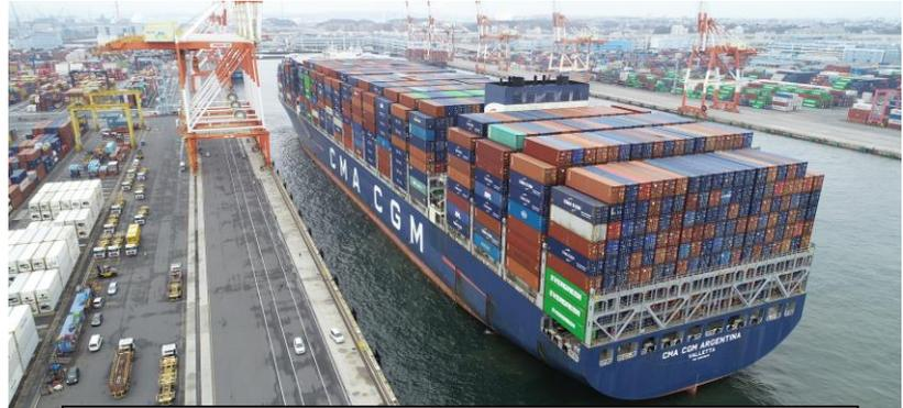
全長:約366m 幅員:51m 最大コンテナ積載数:15,074TEU
