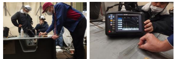
写真-2 LAHW施工後の詳細調査(超音波探傷試験)の様子
