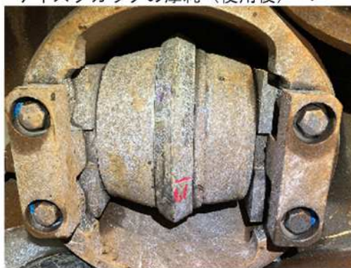
ディスクカッタの摩耗 (使用后)
