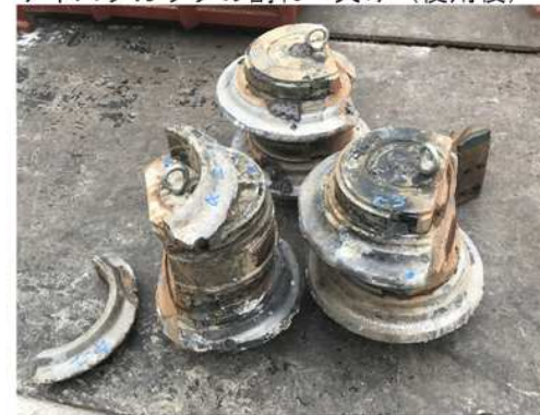
ディスクカッタの割れ・欠け (使用后)
