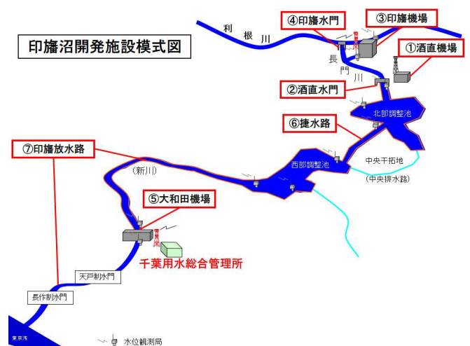
図一 1 印旛沼開発施設模式図
