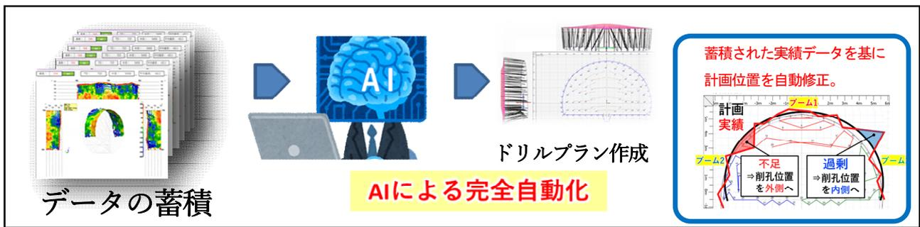
図-11 発破掘削の最適化システムの構造
