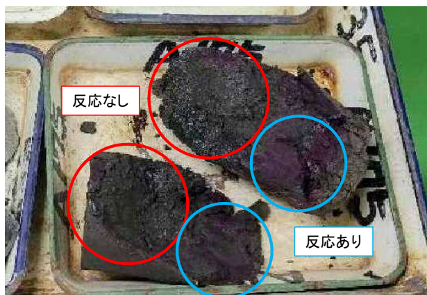
図-4 強度不足改良体コアのフェノールフタレインの反応
