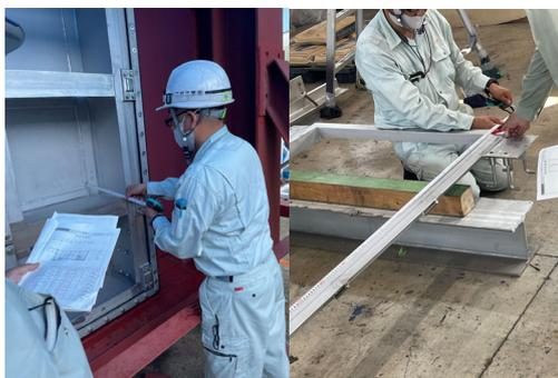
写真-3 工場検査 寸法検査
