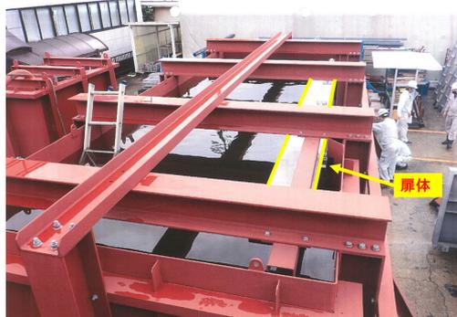
写真-1 工場検査 スライド式防潮扉 仮設水槽 (約 $W8,250\times D3,500\times H3,040$ )
