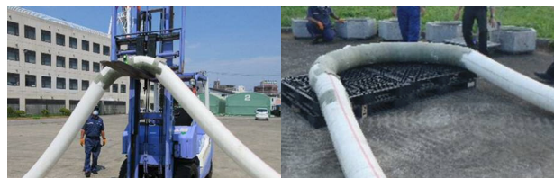
図-6 機能試験（左：壁乗り越え、右：階段踊り場）
