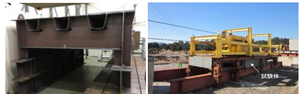
図-10 輪荷重走行試験体(左)と輪荷重走行試験の様子(右)
