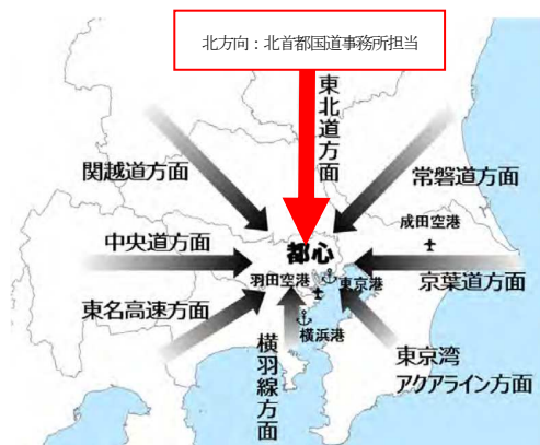
図-1 首都直下地震に備えた“八方向作戦”による道路啓開
