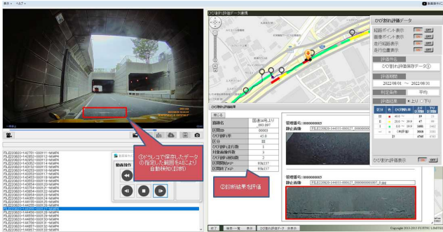
図-2 AIによる舗装損傷（ひび割れ）の自動検知
