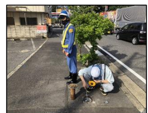
写4 地表面の高さ測定
