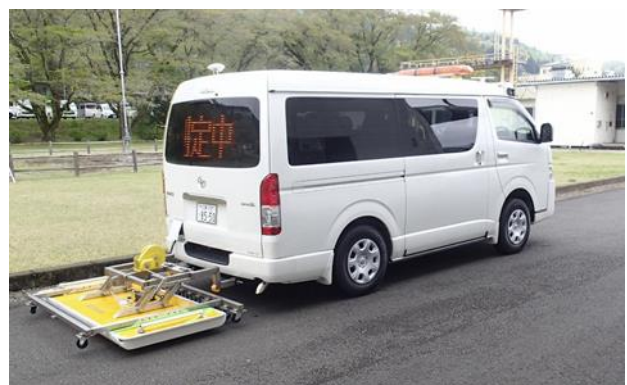
写3 路面下空洞調査
