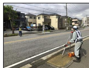
写4 地表面の高さ測定
