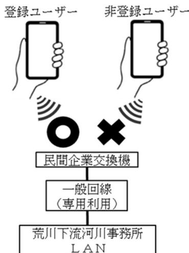
図-5 民間の一般回線を専用的に利用するシステム (イメージ)
