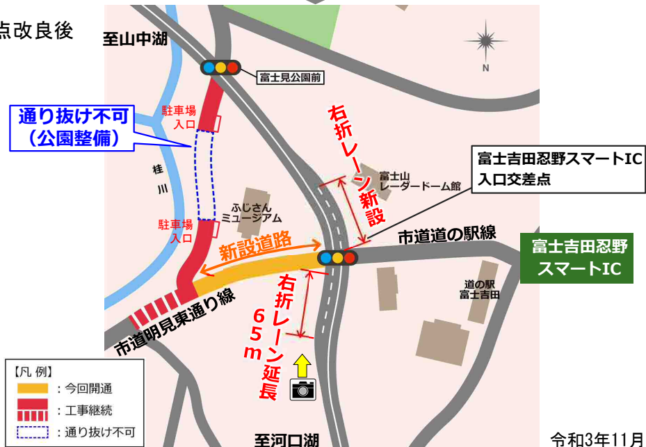
図 2-3 富士吉田忍野スマートIC入口交差点の改良
