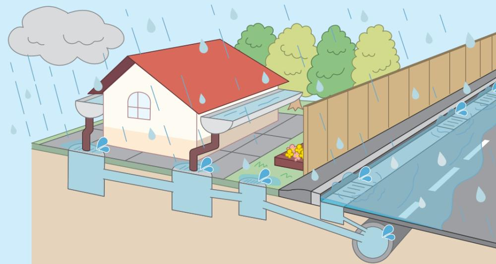
雨水浸透ます・雨水浸透管を設置すると
