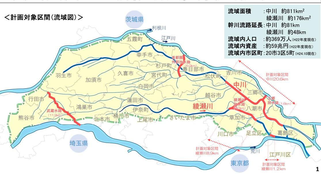
■ 河川整備計画の目標を達成するために、堤防の整備、河道掘削、中川から江戸川へ排水する新たな放水路等の整備を行う。
