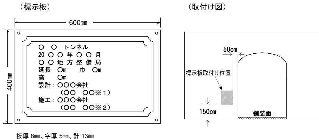
図10-6-2 標示板の設置イメージ図
