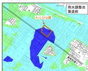
流出解析モデルによる浸水シミュレーション 計画降雨条件 5年確率 55mm/h 流出係数C=0.65
