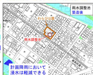
流出解析モデルによる浸水シミュレーション 計画降雨条件 5年確率 55mm/h 流出係数C=0.65
