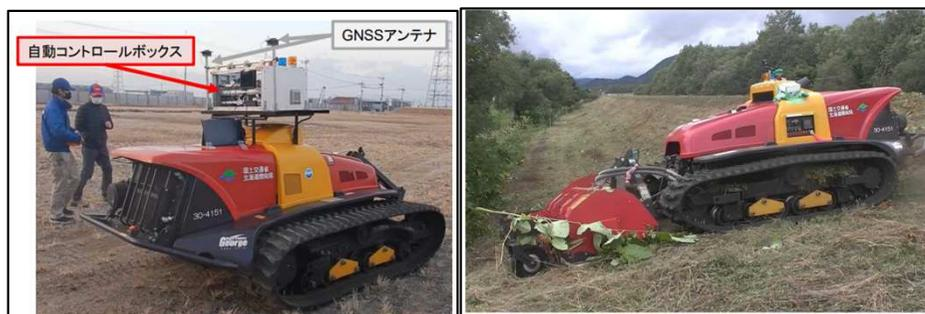
・遠隔式大型除草機に自動化システムを搭載することで、自動運転(除草)を実施することができる。
