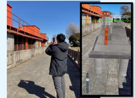
ウェアラブルデバイス（AR）やスマホを用いて、3D河川管内図のバーチャル映像を現実空間に重ね合わせ可能に（実験中）
