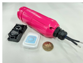
実証実験に用いている3種類の浸水センサ
