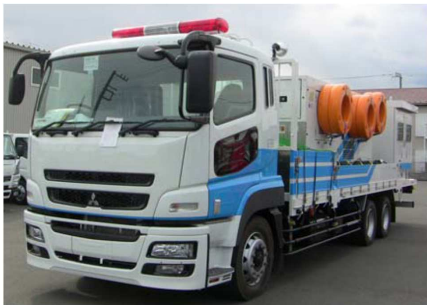
排水ポンプ車
