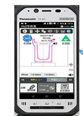
水平離れ、観測点法長などをリアルタイムに確認しながら構造物の誘導/据え付けが可能
