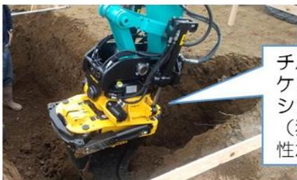
チルトローテートバケット使用によるマシン移動回数の低減(狭小現場でも作業性が低下しない)
