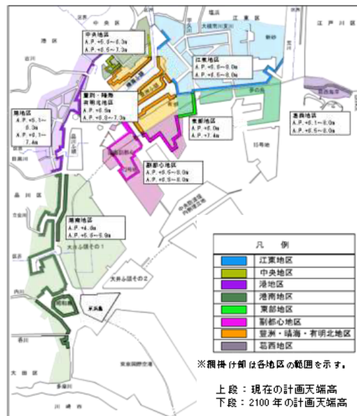
各地区の防潮堤の現在の計画天端高及び将来の計画天端高
