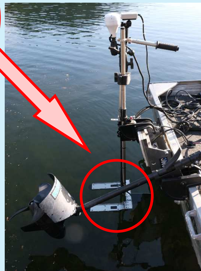
振動子設置状況
