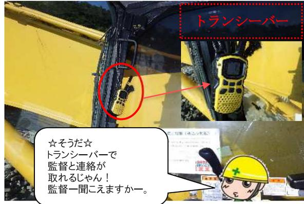
盛土材採取場については、全く不通状況であったので重機オペレーターにトランシーバーを渡し連絡手段の確保を行いました。これらの対策を行うことにより、緊急時に連絡が素早く行える体制としました。
