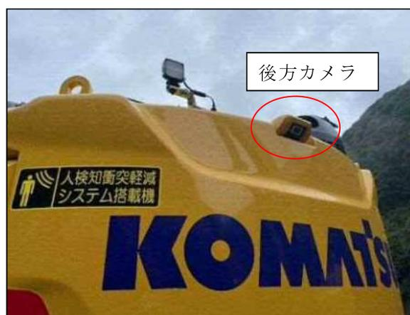
写真・2 人検知衝突軽減システム搭載機
