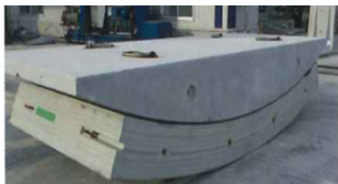
2.0m幅プレキャストインバート例 横浜環状北西線(内径11.5m)
