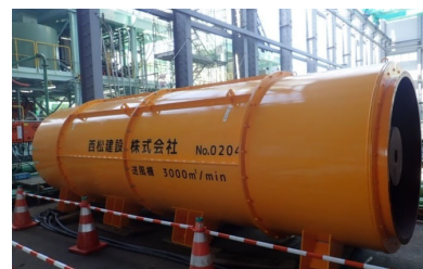
大型ファン(風量3,000m³/min) 立坑地上部、シールドマシン 背後に設置
