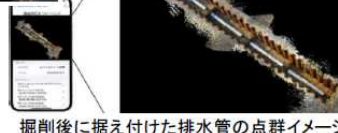
掘削後に据え付けた排水管の点群イメージ
