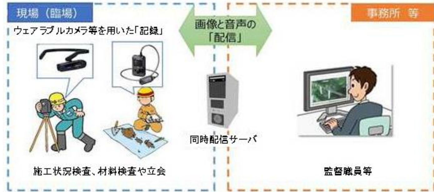
図5-2 遠隔臨場システム例
