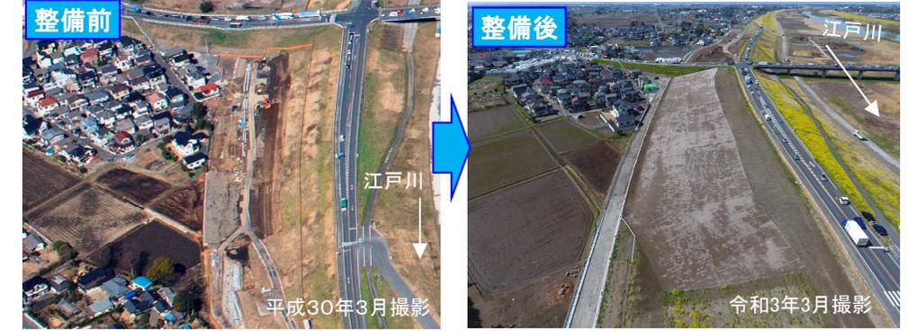
堤防の侵食対策として、河岸の局所洗掘など堤防の安全性が脅かされる恐れのある箇所において、高水敷造成や護岸整備等の対策を実施
