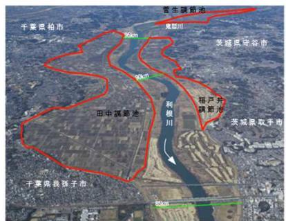
▲鬼怒川合流点付近に整備している洪水調節施設(田中調節池、菅生調節池、稲戸井調節池)
