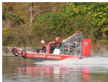
エアポートにより水面から被災状況を調査
