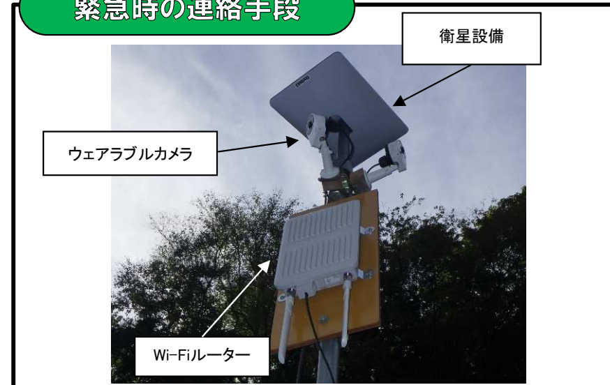
衛星通信設備を設置し、緊急連絡手段を確保 ウェアラブルカメラにより、遠隔で現場の状況把握が可能
