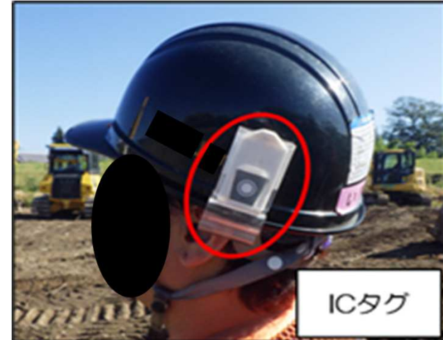
ICタグの活用 (重機に作業員が近づいた場合に、重機オペレーターへ警告)
