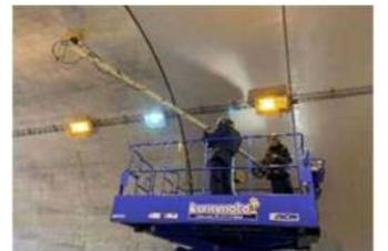
レーダーを利用したトンネル覆工の損傷把握
