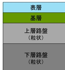
(一般的なアスファルト舗装の構成)
