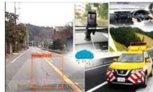
パトロール車両に搭載したカメラからのリアルタイム映像をAI技術により処理し、舗装の損傷を自動検知
