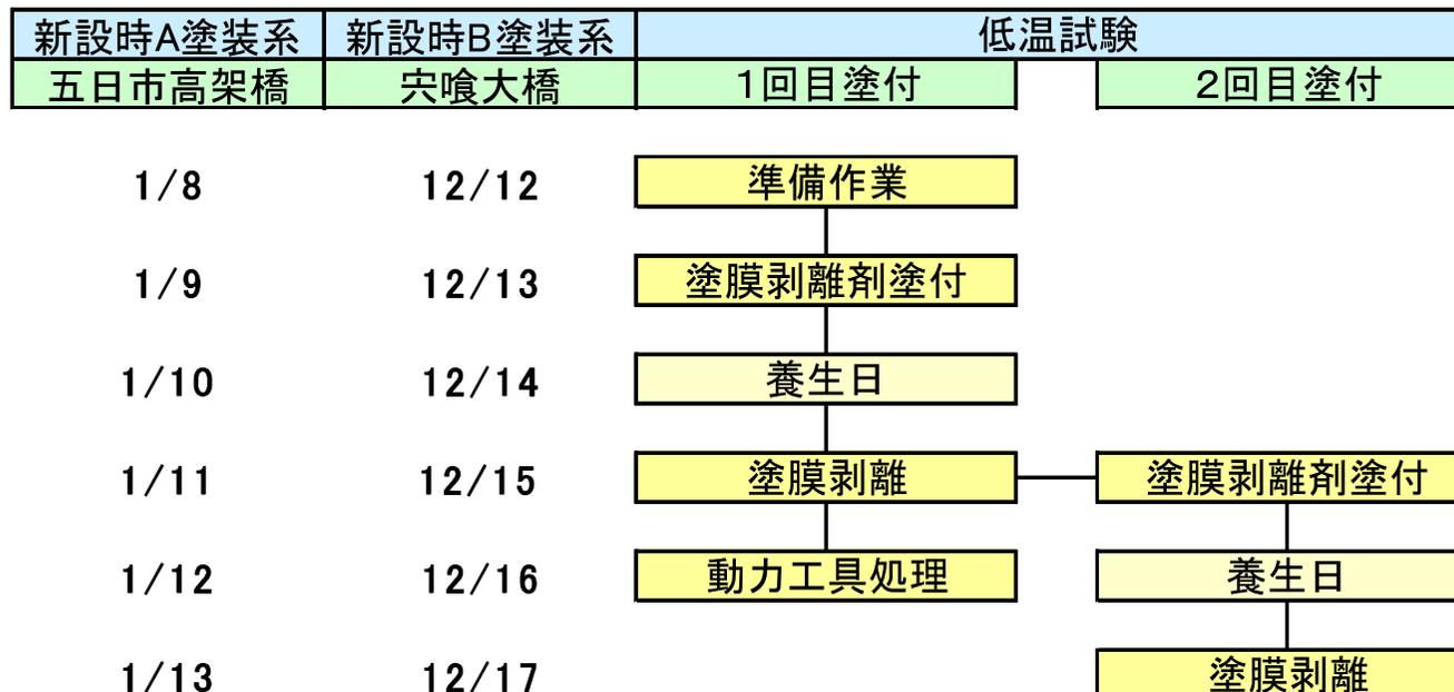
※塗膜剥離は、刃付スクレーパー(幅100×厚さ0.8mm片研ぎ刃)を使用し、同一作業者により実施
