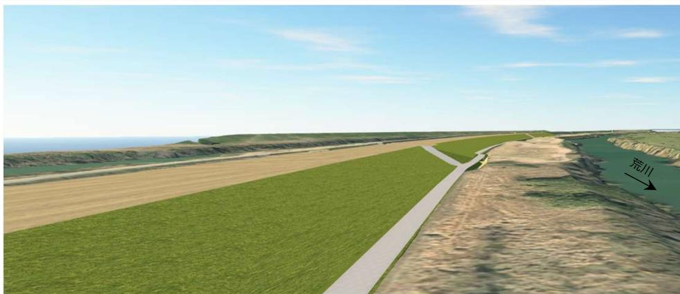
荒川左岸側に調節池を整備することに合わせて、洪水を安全に流すため、荒川右岸堤を嵩上げています。
