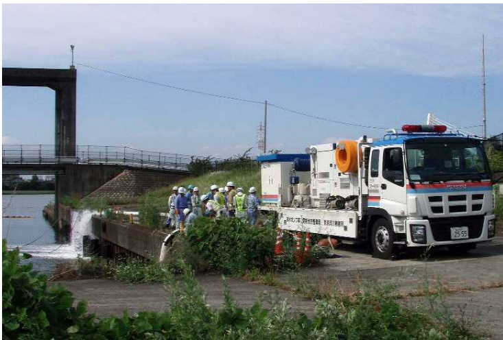
▲排水ポンプ車
