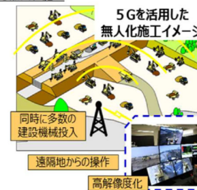
大容量・低遅延・多数同時接続の特性をもつ5Gを活用し、無人化施工の生産性を向上。ポストコロナによる、非接触型・リモート型の働き方への転換。
