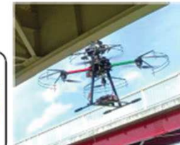
ドローンによる損傷把握
