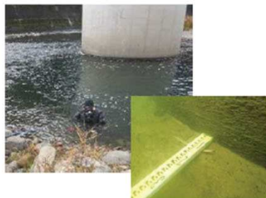
潜水調査による河床洗掘の把握
