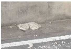
コンクリート片(40cm×25cm×9cm) 県道上に落下
