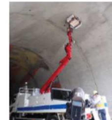
レーザー打音による変状の把握
