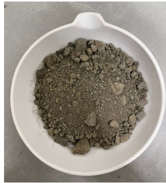
図1 藤枝PA 泥岩の外観
