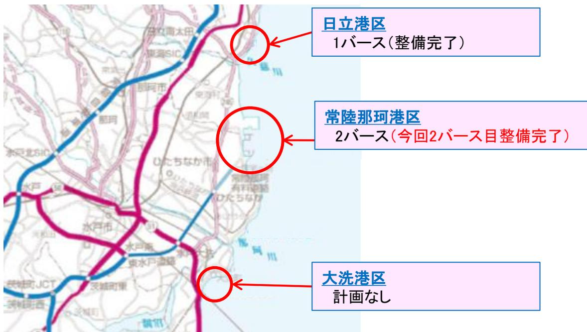
図3 茨城港の耐震強化岸壁（緊急物資輸送対応）の計画と整備状況
