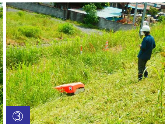
UNIMOWERS （傾斜地でパワフルに使える電動草刈り機） 株式会社ユニック
