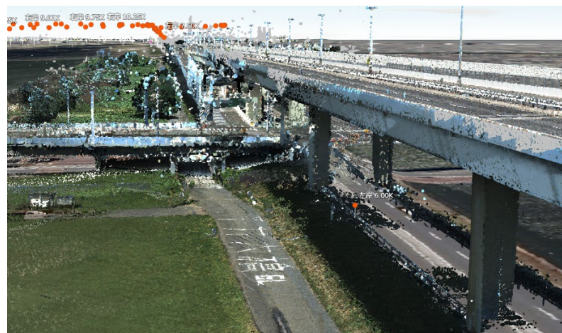
図 27 三次元点群データの例
