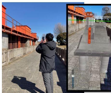
図 16 AR による構造部の不可視部分（基礎）の見える化（イメージ）
