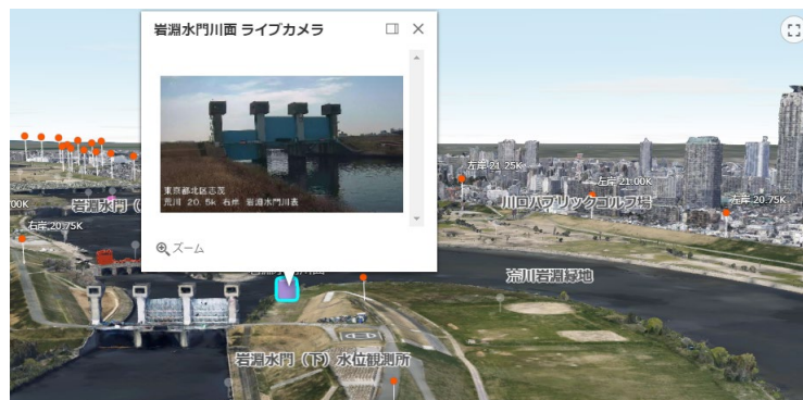
図 15 三次元河川管内図の CCTV 画像表示
