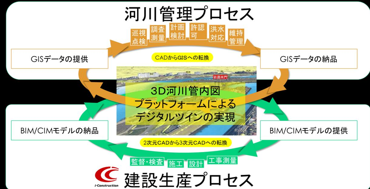
河川管理プロセスと建設生産プロセスをつなぐ三次元河川管内図プラットフォーム
