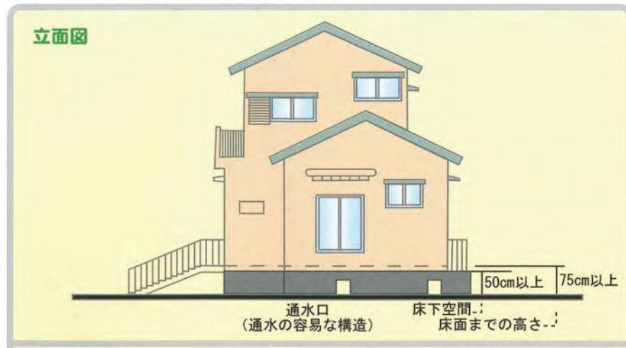
高床化工事の例
