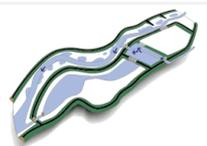
調節池排水門を閉め、調節池としての容量を確保します。昭和水門、さくらそう水門はサクラソウ自生地の冠水頻度を変えないために、洪水初期または小洪水時には開かれています。
