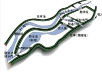
最下流の調節池排水門は開いており、貯水池「彩湖」の水位調節は、水位調節堰で行います。鴨川の荒川への合流は、昭和水門、さくらそう水門を開いておくことにより行います。
