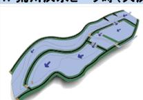
上流ブロックに流れ込んだ洪水は上流ブロックを満たした後、次のブロックの入口である流入堤より貯水池(彩湖)ブロックへ流入し、所定の洪水調節が行われます。荒川の流量の低減に伴い、調節池の排水を行います。
