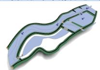
調節池排水門に加えて、昭和水門、さくらそう水門も閉められ、鴨川の排水はポンプ排水となります。上流の越流堤より流入が始まり、洪水調節が開始されます。
