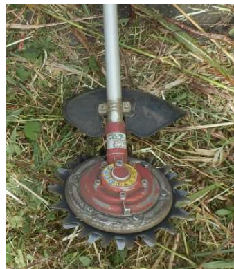
R1年度より、飛び石事故防止対策として「上下刃逆回転式機械」を採用している
