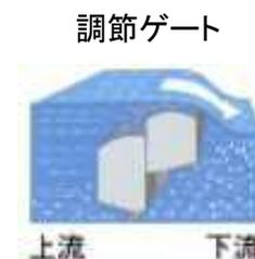
※ 堰の上流水位が下流水位よりある程度高い時を 順流 と定め、調節・制水ゲートを開けて放流を行っている。
