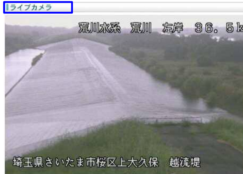
荒川第一調節池越流堤の例
