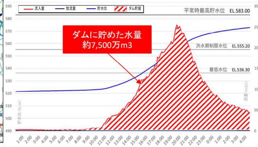
ハッ場ダムの洪水貯留状況
