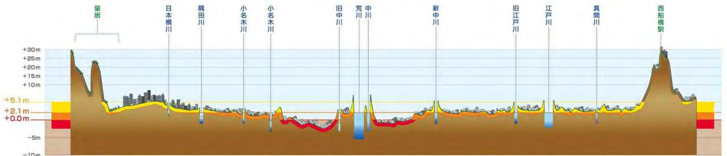
●A.P.とは、荒川工事基準面のことで、標高(T.P.)+0.0mはA.P.+1.134mです。
