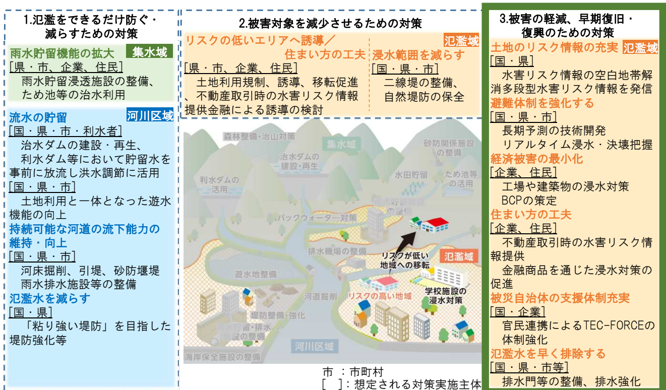
図2.7 「流域治水」の3つの施策のイメージ（被害の軽減、早期復旧・復興のための対策）
