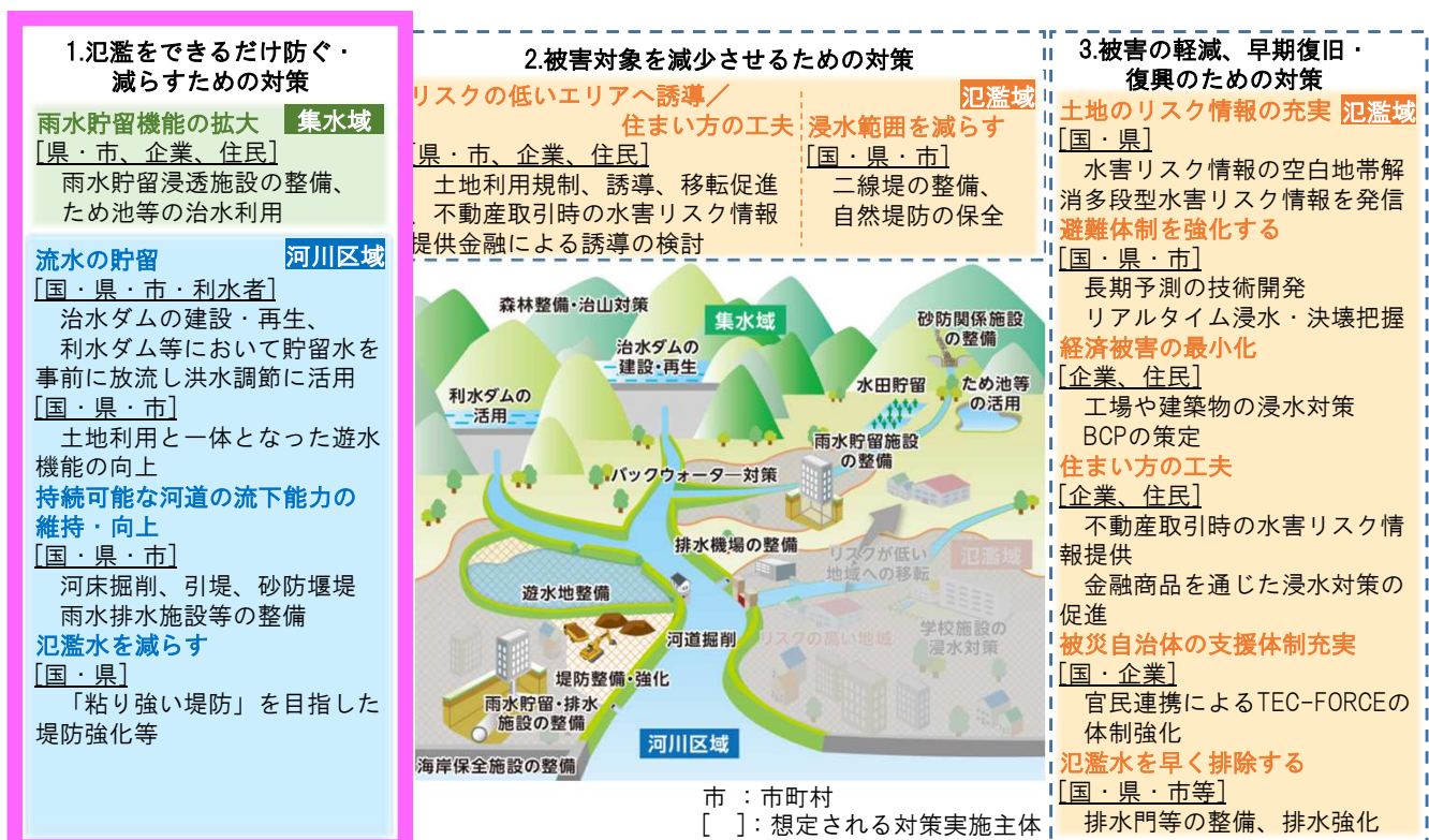
図2.2 氾濫をできるだけ防ぐ・減らすための対策の概要
