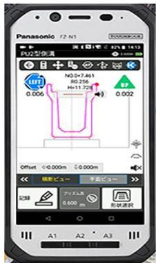
水平離れ、観測点法長などをリアルタイムに確認しながら構造物の誘導/据え付けが可能
